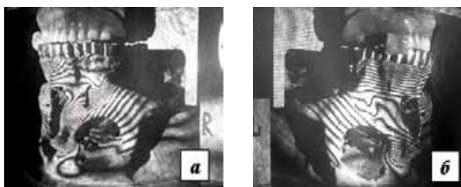
Рис. 5. Интерферограммы исследуемого объекта, правая сторона – а, левая – б, при нагружении зубов 2.3 и 2.4 (МП вариант № 3)
