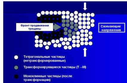
Наиболее полезные механические свойства могут быть получены, когда диоксид циркония будет находиться в многофазном состоянии. Стабилизаторы позволяют получить многофазный материал при комнатной температуре, в которой кубическая (С) - главная фаза, а моноклинная (М) и тетрагональная (Т) - второстепенные фазы.
